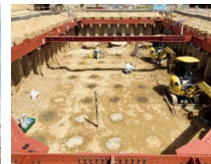
試験土槽内の改良体掘り起こし状況
