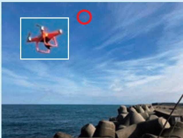
港湾構造物の点検のため、海上を飛行するドローン
