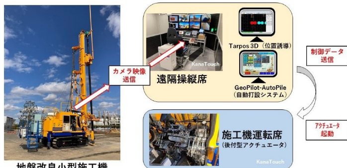
地盤改良小型施工機
