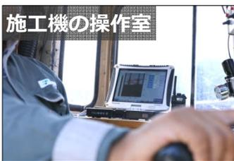
施工機の操作室に設置した Visios-3D のモニターがアニメーションで施工状況を表示
