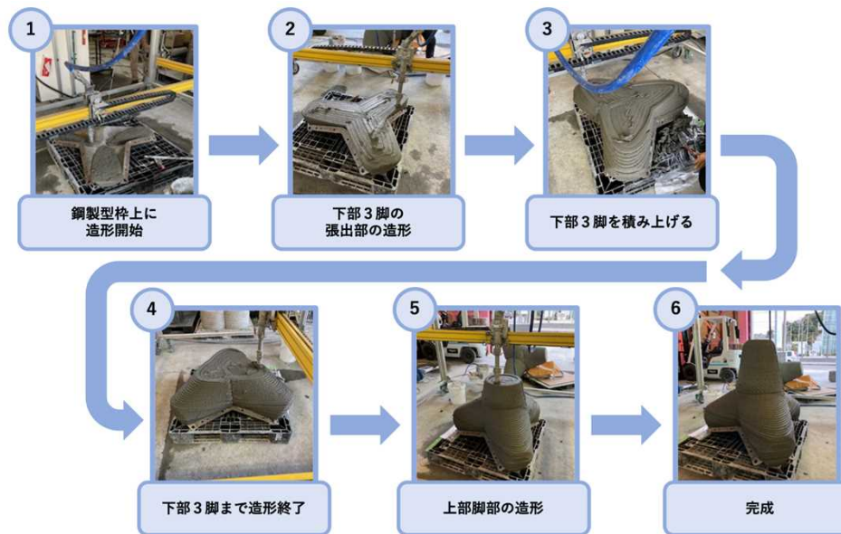
3Dプリンタで造形したテトラポッド（0.5トン型相当）
