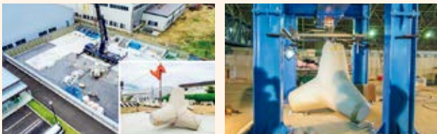
ブロックの衝突落下実験
