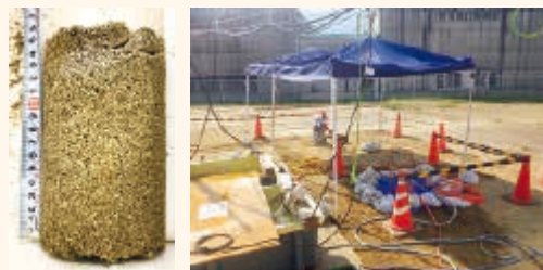
バイオセメントで固結した砂
