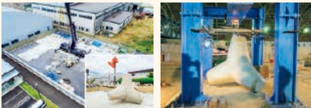
ブロックの落下衝突実験
