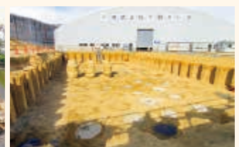
試験土槽内の改良体掘り起こし状況
