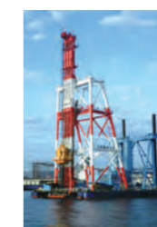
海上地盤改良船： 深層混合処理船「CMC7号」
