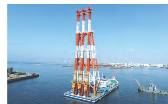
海上地盤改良船： サンドコンパクション船「ばいおにあ第30ブドウ丸」
