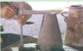
大切な材料管理、スランプ試験
