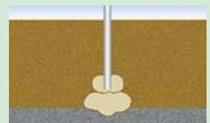
●ボトムアップ方式 改良範囲の下端から上部に向けてステップアップしていく。
