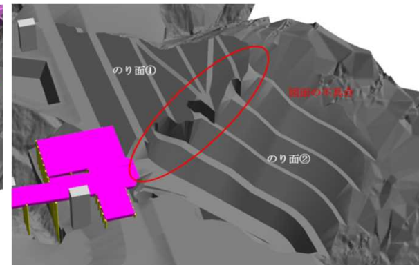
のり面擦り付け部の不具合
