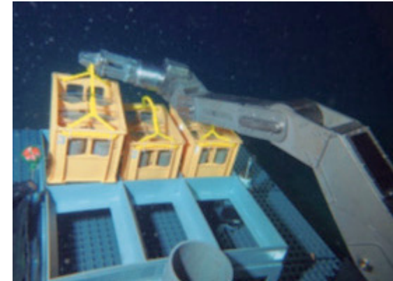
「しんかい6500」により水深3500mに運搬され、プラットフォーム上に設置されたコンクリート供試体の様子 （写真は3つ目のプラスチック容器を設置中の様子）
