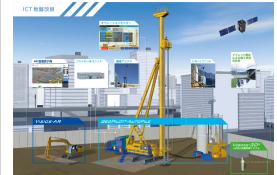
ICT地盤改良
