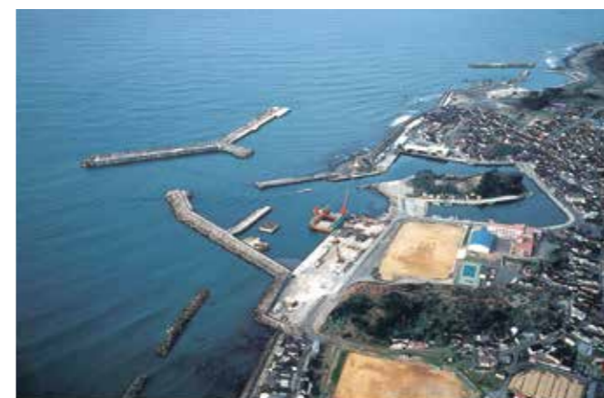
金浦漁港(秋田県) 事業主体:秋田県 施設名:防波堤 備考:自然調和型漁港 一部に透過型
