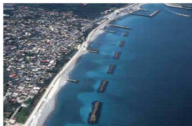
新島港海岸(東京都) 事業主体:東京都 施設名:離岸堤 備考:港湾海岸
