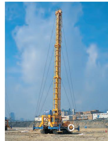
特殊圧入装置を使った硬質地盤対応型工法(パワーブーストドレーン工法)も用意しています。
