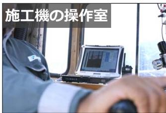
施工機の操作室に設置した Visios-3D<sup>®</sup> のモニターがアニメーションで施工状況を表示
