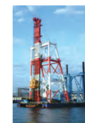
海上地盤改良船： 深層混合処理船「第7不動号」
