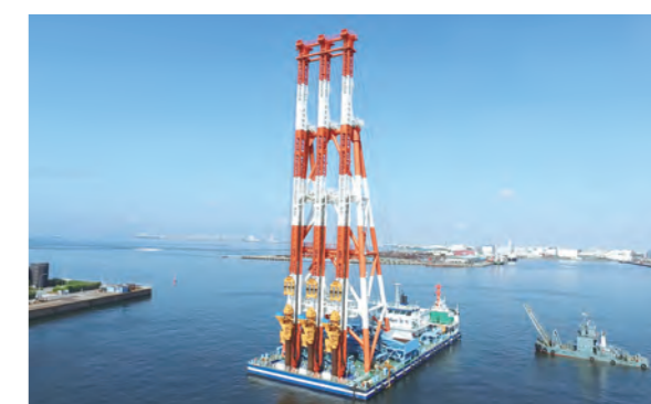
海上地盤改良船： サンドコンパクション船「ばいおにお第30フドウ丸」
