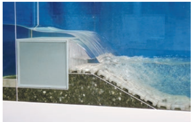
津波越流の模型実験
