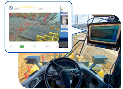
最新のAR(仮想現実)技術を用いた 施工ガイダンスシステム
