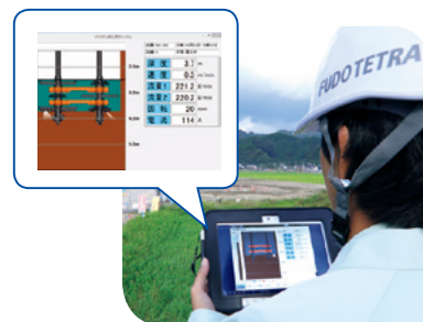
遠隔地でも地盤改良施工機の作業状況がわかるシステム
