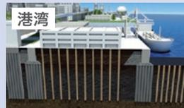
●護岸・岸壁、防波堤の沈下安定・支持力対策
