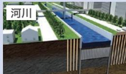
●河川改修・築堤の安定・支持力対策
