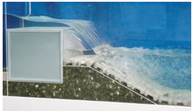
津波越流の模型実験
