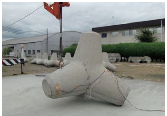
テトラポッドの落下実験
