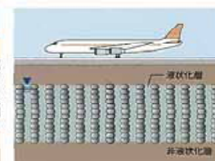
● 滑走路下部 滑走路下液状化層の改良で沈下を防止
