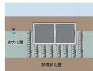
● 地中構造物 液状化層の改良で浮き上がり・傾きを防止
